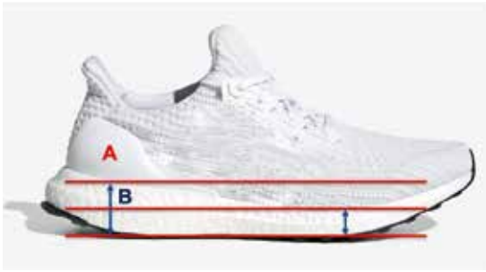
Abbildung 4: Moderner Sportschuh. Der Bereich des Rückfusses (Bereich A) ist sehr hart und stabil. Der Fuss kann nicht nach innen wegknicken (Pronation). B: Sprengung bzw. Absatz: Es besteht ein Unterschied zwischen dem vorderen und dem hinteren Anteil der Sohle.
