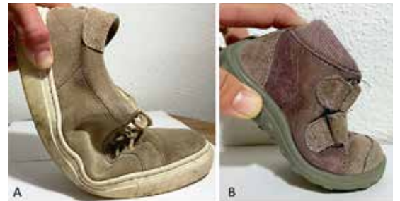
Abbildung 3: A: Der Schuh knickt zu weit hinten im Bereich des Mittelfusses. Es entsteht eine unphysiologische Biegebelastung des Fußes. B: Der Schuh knickt, wie gewünscht, im Bereich des Zehengrundgelenks.
